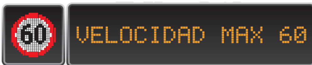
Figura 8.4-2 Señal de una Línea acompañada de Panel Lateral Suplementario
