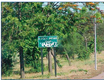
La señalización rayada, envejecida, o caída, no puede ser percibida en forma óptima por los conductores, generando situaciones de riesgo que pueden terminar en un accidente
