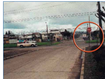
Intersecciones con buena visibilidad y señales "Pare" instaladas incorrectamente
