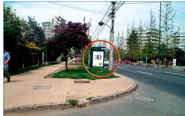
Paradero y poste obstaculizan la visual de los conductores que acceden por la calle secundaria
